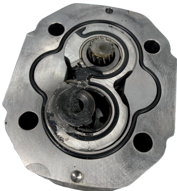
▲ Neúnosná zátěž čerpadla Q2 způsobila projetí hnaného kola do tělesa, následné zadření a ulomení spojky
