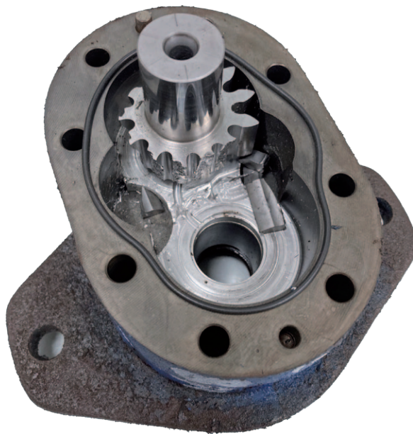
▲ Přetížené čerpadlo GHD0 s ulámanými zuby na hnaném kole
