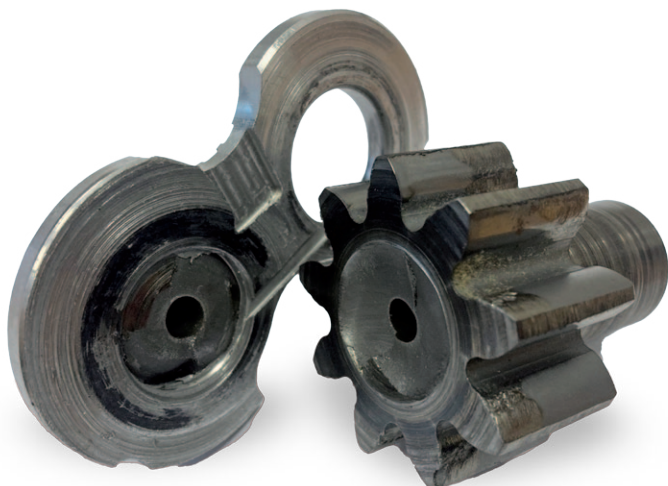
▲ Příklad přetížení čerpadla GHD0 u zákazníka – zadřený a prasklý čep hnaného kola
